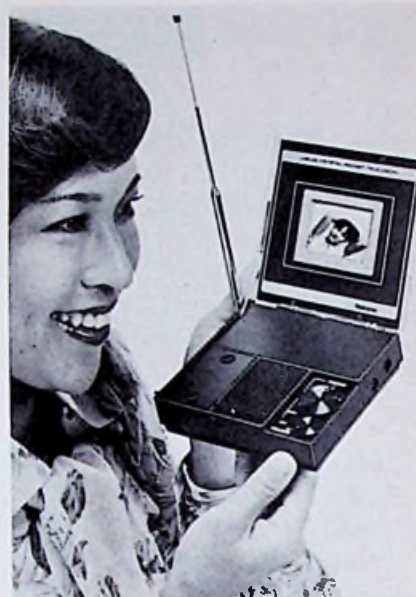
Bild 1. Schwarz-Weiß-Taschenfernsehempfänger mit Flüssigkristallanzeige
